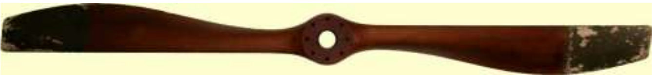
An actual propeller (linen wrap protected tips)
