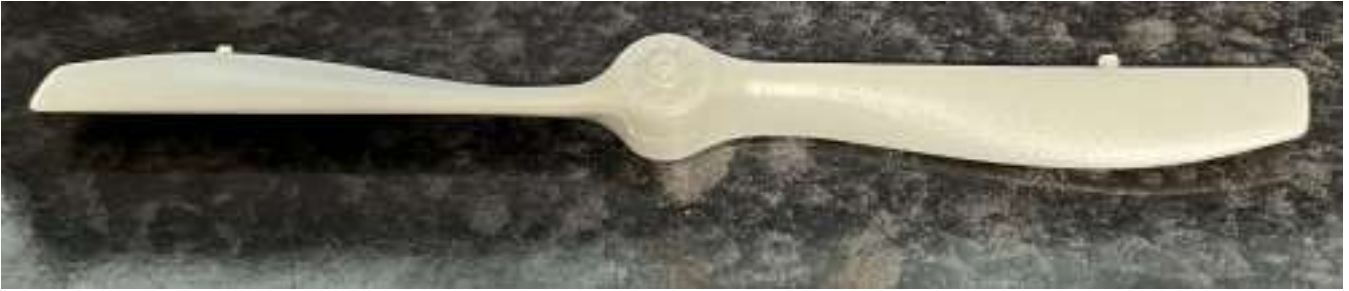
An actual propeller (linen wrap protected tips)
